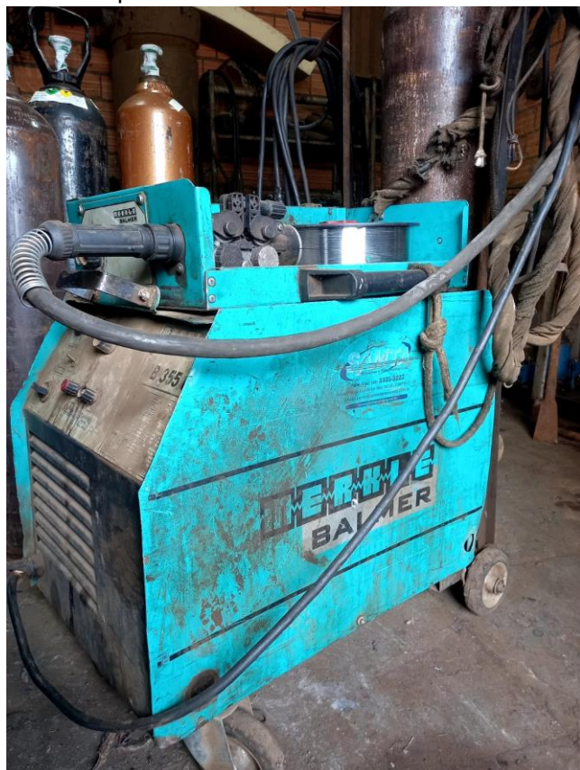
Cód 15 - Aparelho de solda Merkle Balmer MB 355 D
