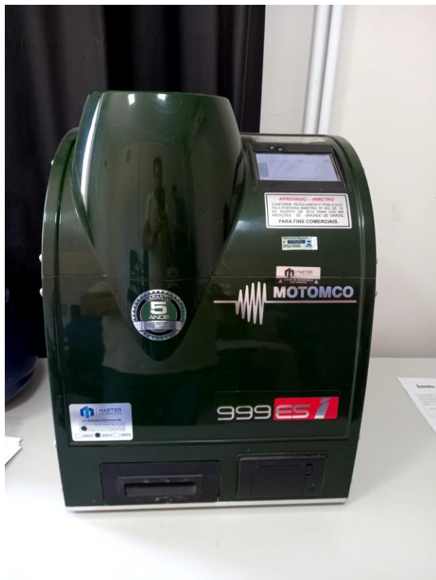
Cód. 18 - Medidor Umidade Grãos Motomco - Serie SIMT-13794
