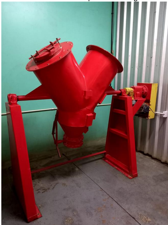
Misturador de Pó em Y – Capacidade 100Kg
